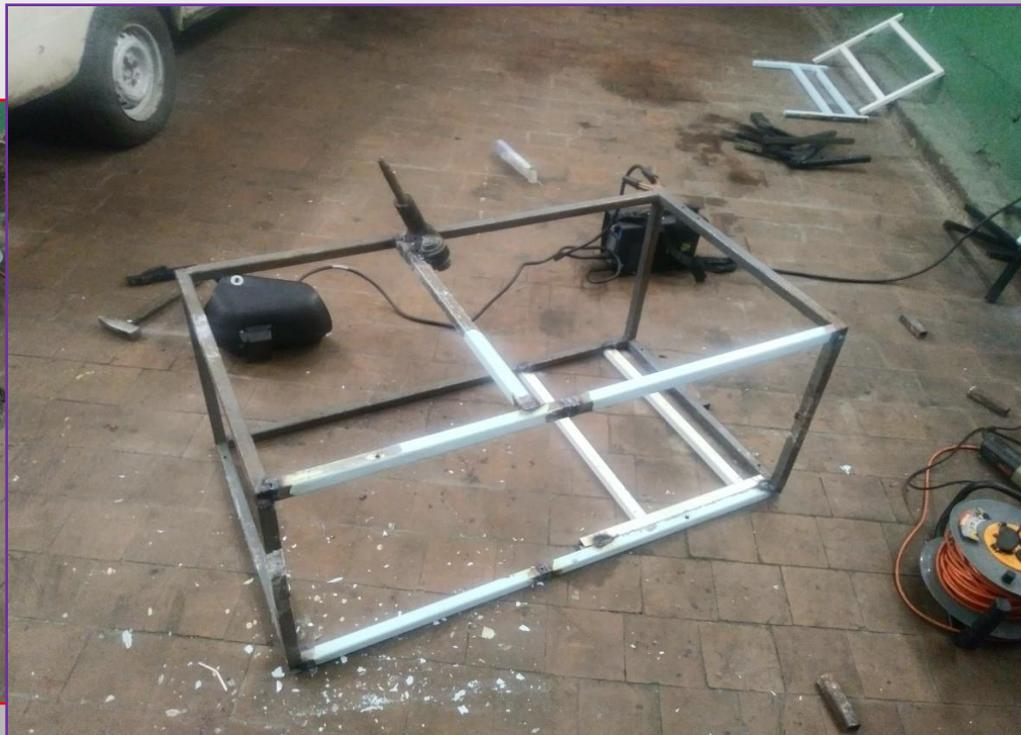
2. Была приварена рулевая колонка и площадка для генератора, стартера и аккумулятора
