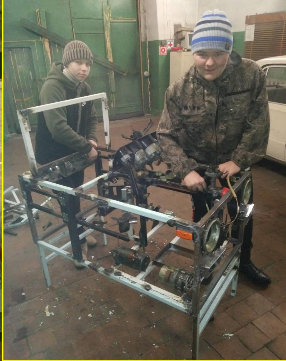
На предварительной сборке , мы собрали стенд без покраски и проводки, чтобы понять как он будет выглядеть и расположение агрегатов. Стенд готов к покраске.
